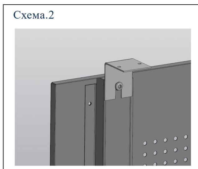
5. Установите Винт M6x10 ISO с шайбой 6Ц во втулку стойки (см. схема 2) не затягивая. Вставьте кронштейн как указано на схеме 2. Протяните все крепежные элементы.
